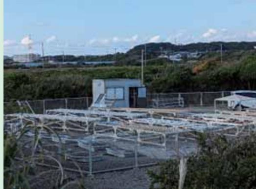
■ 設置状況 (方向: 南面、取付角: 45度、地上高: 1m)
