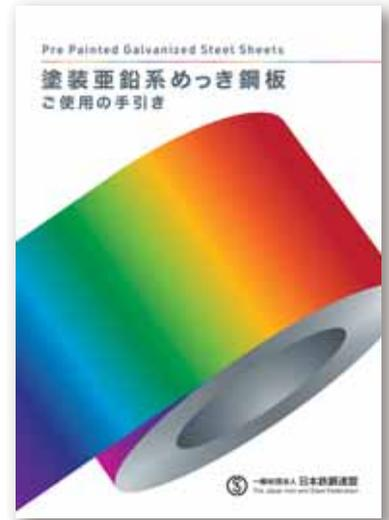
塗装亜鉛系めっき鋼板は、亜鉛系めっき鋼板に合成樹脂塗料を塗装・焼き付けすることによりめっき層中の亜鉛の犠牲防食作用（亜鉛が溶け出すことで、鉄が錆びるのを防止する作用）とともに、塗膜によるめっき層の保護・隔離作用で、亜鉛系めっき鋼板より優れた耐久性を有します。また塗膜に意匠性、機能性を付与することで種々の用途に対応してきました。前回（2014年）の見直し後、9年が経過しJISの改正も行なわれており、改正内容を反映した内容にすべく、改訂を行ないました。
