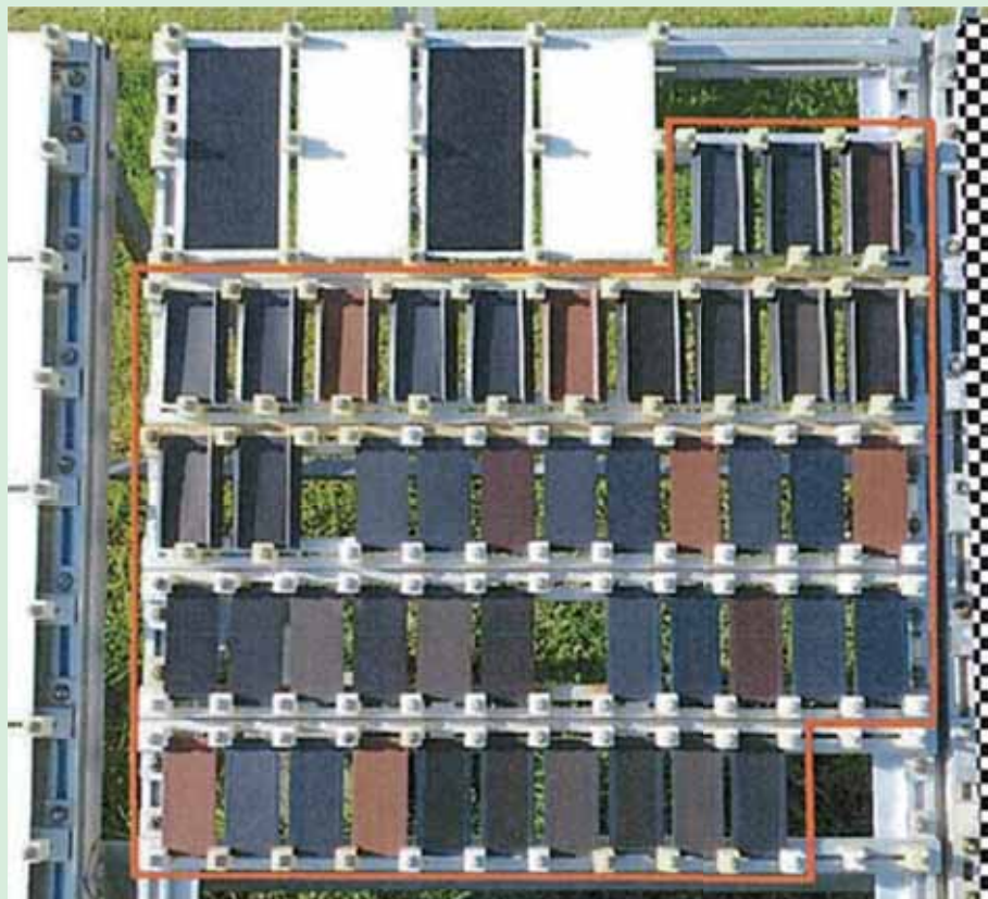
③「南面暴露」設置状況(方向:南面、取り付け角:45度、地上高:1m)
