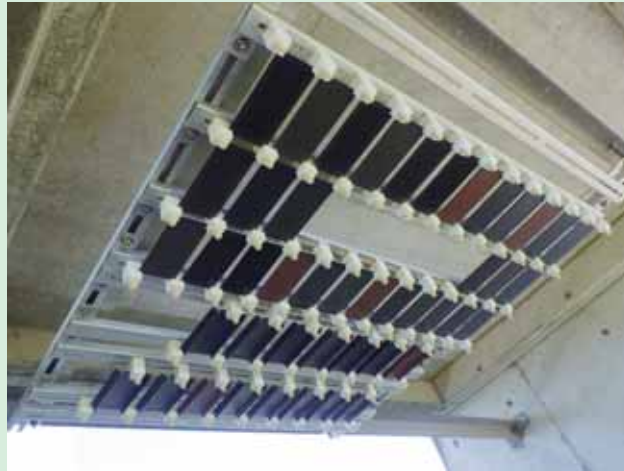
②「軒下暴露」設置状況(方向:地面、取り付け角:水平、地上高:1m)
